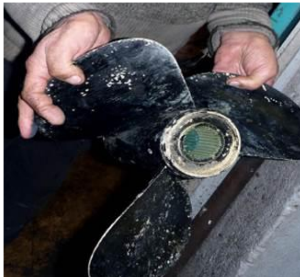
Nimo 22 Duoprop efter 6 månader, LE 5100 Pyroshield kvar
